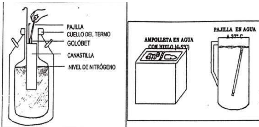
Esquematzación del procedimiento para sacar la dosis del termo de nitrógeno (A) y de descongelación a 4.5° C o a 37° C (B).
